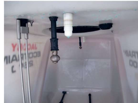
Cuve de pulvérisateur munie d'une buse de rinçage, agrotop.
