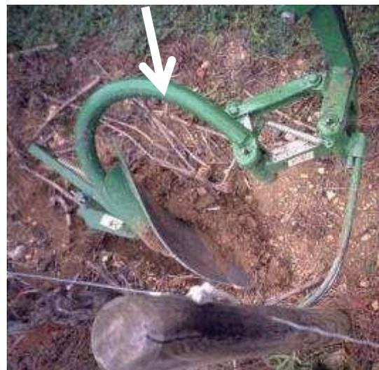
Mouvement frontal grâce au **parallélogramme** déformable
