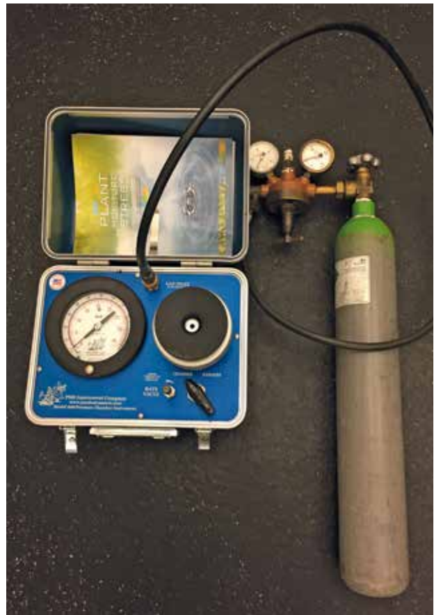
Figure 7 | Appareil de mesure du potentiel hydrique (chambre à pression de Scholander).
