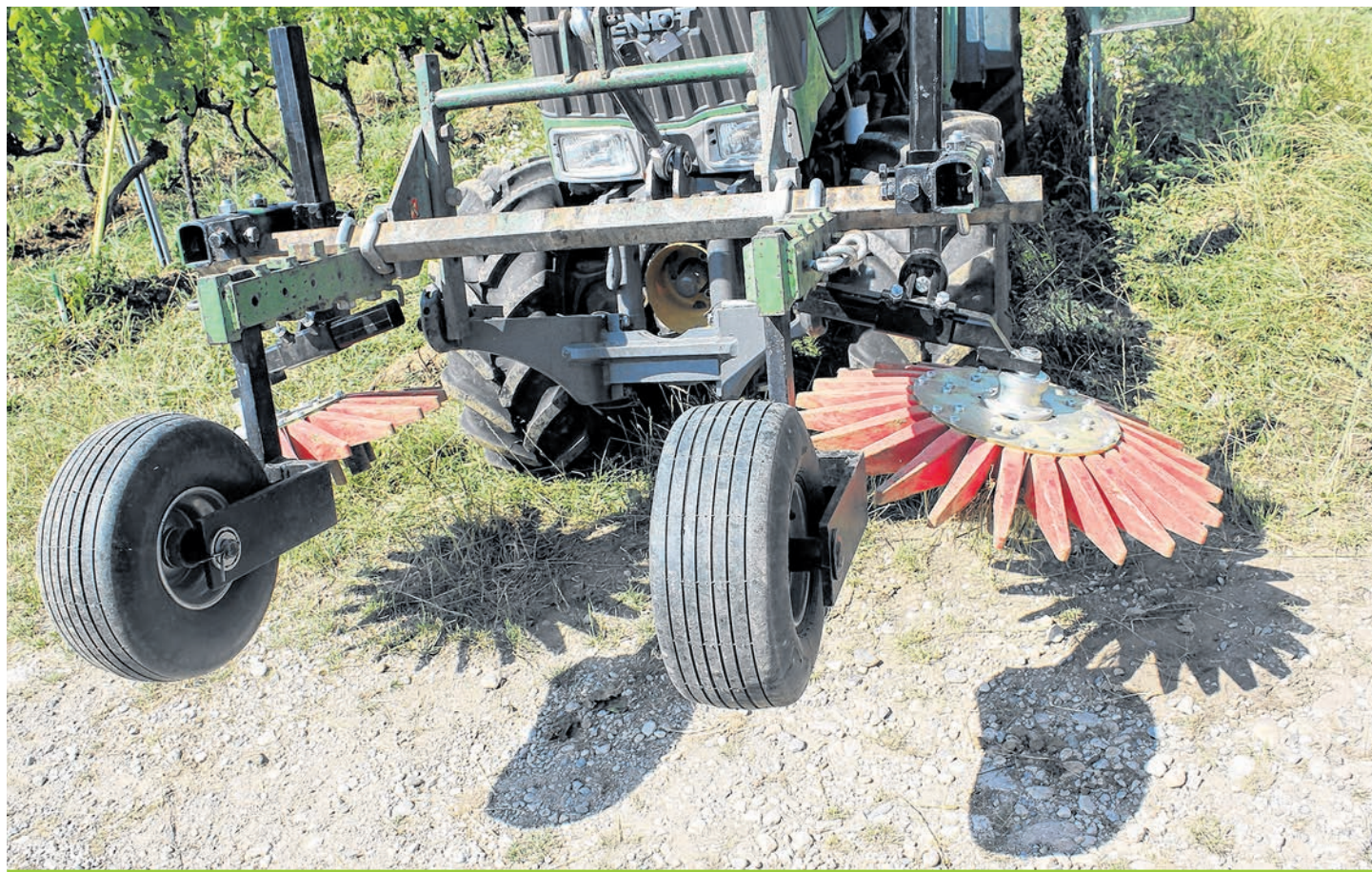
Les outils de désherbage mécanique, de plus en plus performants, sont une alternative à l'emploi des herbicides.
